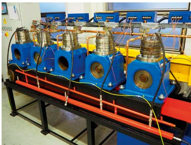
informático dispone de una amplia gama de opciones para configurar la ejecución del ensayo de acuerdo con los requisitos especiales de trabajo. Se trata principalmente de controlar la velocidad del motor, la carga de los rodamientos y ajustar las condiciones de lubricación.
