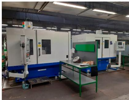
lumen de medición y capacidad para procesar piezas de trabajo muy pesadas. El dispositivo aumenta el rango de medición para la verificación de las condiciones tecnológicas de rectificado de diámetros de rodamientos nuevos en desarrollo hasta 500 mm.
