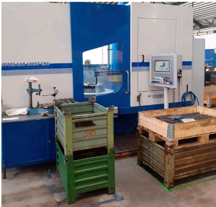
En 2020, el segmento de rectificado de elementos rodantes para rodamientos de dimensiones grandes ha sido reforzado significativamente. Se entregó una rectificadora frontal de discos de segmento CNC JOTES SAB 100ST para el sector de rectificación de elementos rodantes.
