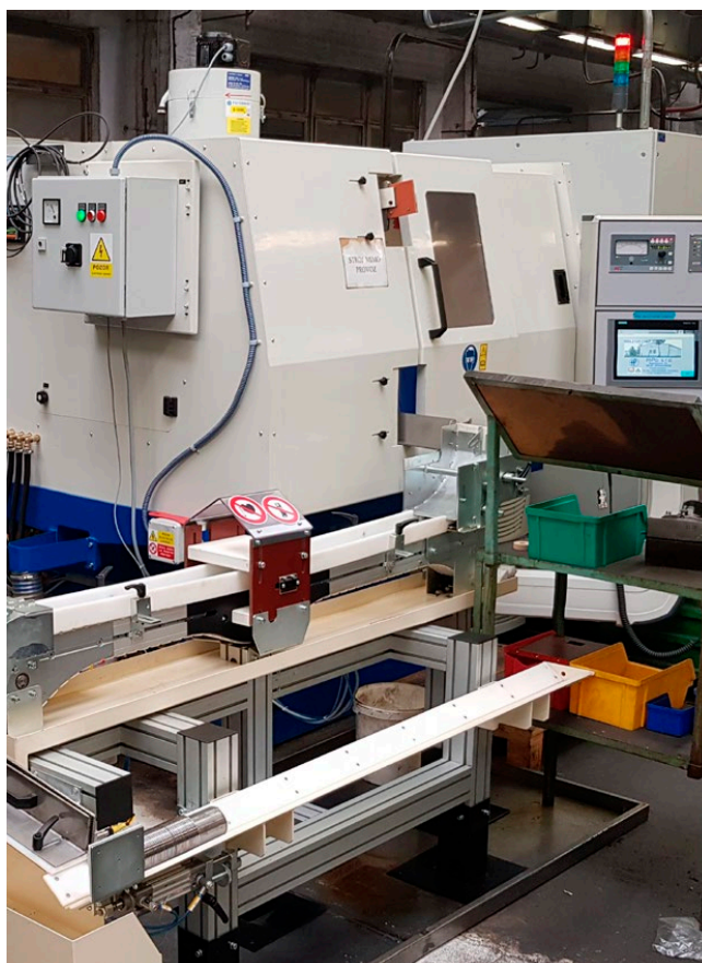
Osazování stroje na přesné broušení ramínek BDLZ 120 CNC HP
