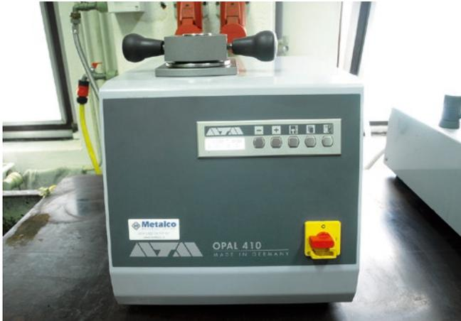
Prensa metalográfica automática Opal 410
