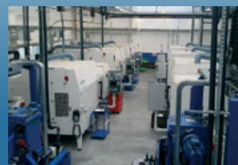
Línea de producción para fabricación de rodamientos cilíndricos en ZKL Klášterec nad Ohří *pág. 5*
