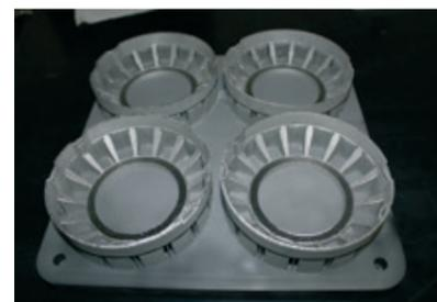
Los prototipos de los rodamientos innovados fueron probados en el Centro de ensayos de ZKL - Výzkum a vývoj con resultados muy positivos en cuanto a los parámetros de funcionamiento (generación de calor, vibraciones) y en cuanto el aumento de la vida útil del rodamiento en comparación con la versión original. Durante el año 2018, continuarán las pruebas operacionales de rodamientos innovados, construcción y verificación de otros tipos y dimensiones de la serie 294.
