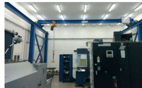
En mayo del año pasado se construyó e instaló en ZKL Tech - Tools, a. s. una pista de grúa de la empresa FANAK s.r.o. para mejorar el manejo de piezas grandes y pesadas. Esta pista de la grúa se encuentra en la planta de operación del Centro de Desarrollo para Herramientas de Prensado.
