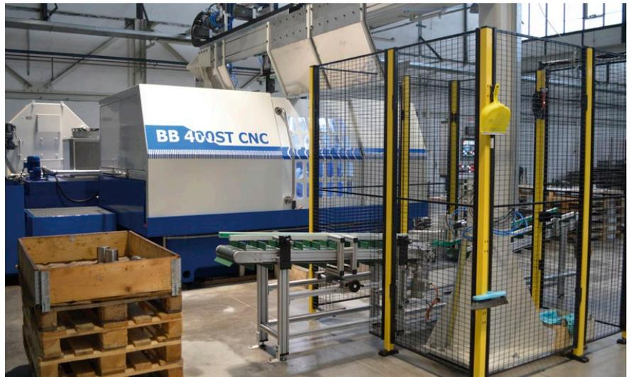
depende del tamaño y el peso de los elementos rodantes. El ranurado de doble ranura es posible aplicar en elementos rodantes de hasta un diámetro máximo de 150 milímetros, una longitud de hasta 200 milímetros y un peso máximo de 15 kilogramos. Para rectificar los elementos rodantes más grandes con un diámetro de 151 a 250 milímetros, una longitud de hasta 250 milímetros y un peso máximo de 40 kilogramos,
