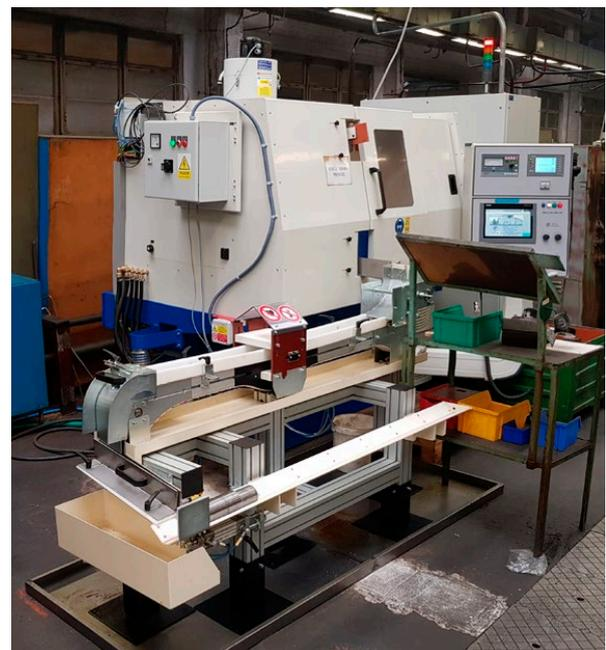
Instalación de la máquina de rectificado preciso de brazos BDLZ 120 CNC HP
