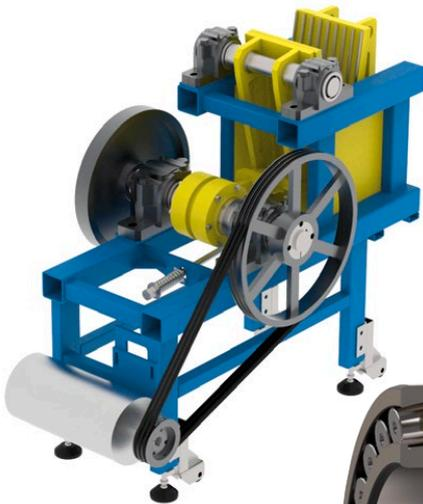
de trituradoras. Las más utilizadas son las trituradoras de mandíbula, impacto y cono. Cada tipo tiene sus ventajas y desventajas. Las trituradoras de mandíbulas tienen una construcción simple, menores costos de operación en comparación con otros tipos y muestran una alta confiabilidad. Por otro lado, no son adecuadas, por ejemplo, para triturar hormigón armado, los granos de este material muestran propiedades de forma inferiores. La
