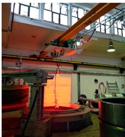
perficie lisa de piezas templadas sin escamas y una alta descarburación de la superficie. El horno está controlado por el sistema de control de Siemens. El control se realiza solo seleccionando el programa apropiado de la memoria del panel de control. El sistema también registra todo el proceso, lo que permite analizar retrospectivamente las condiciones para lotes templados individuales. El horno tiene muy buen aislamiento térmico y bajo consumo de energía eléctrica.
